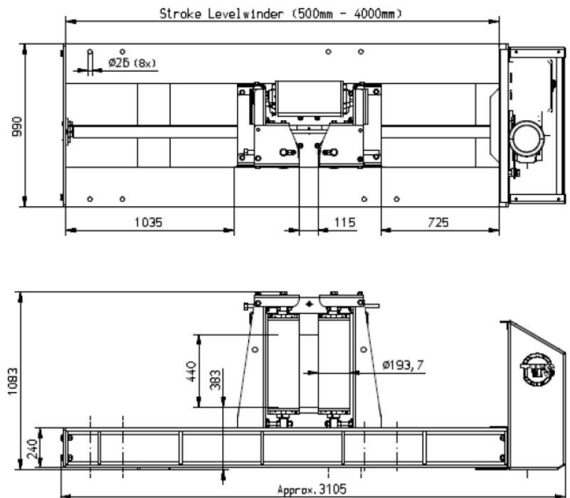
Die TEL5000 ist eine elektrisch angetriebene Seilführung, die mit jeder Winde oder Spule kompatibel ist. Dank der intelligenten Steuerung mit Anzeige zur Messung der Seilgeschwindigkeit und -länge eignet sich die TEL5000 für Seile mit einem Durchmesser von 28-100 mm und Windentrommeln bis zu einer Breite von 1.750 mm. Mit einem Zusatz kann man sogar eine Breite von bis zu 4.000 mm erreichen.
