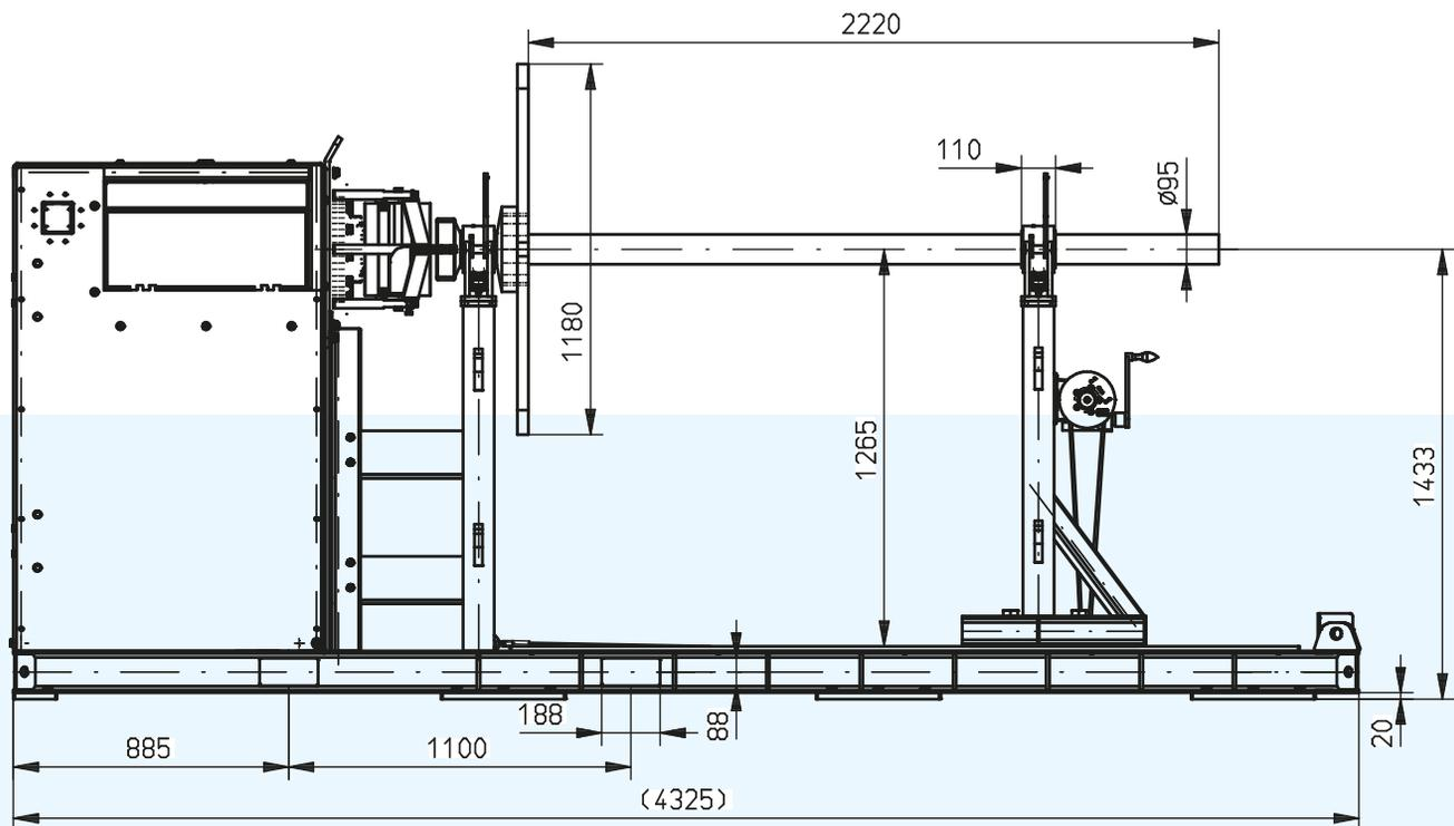
(Zeichnung mit Abmessungen des sehr ähnlichen Seil-Wickelmaschinen-Modells TEH15C.)
