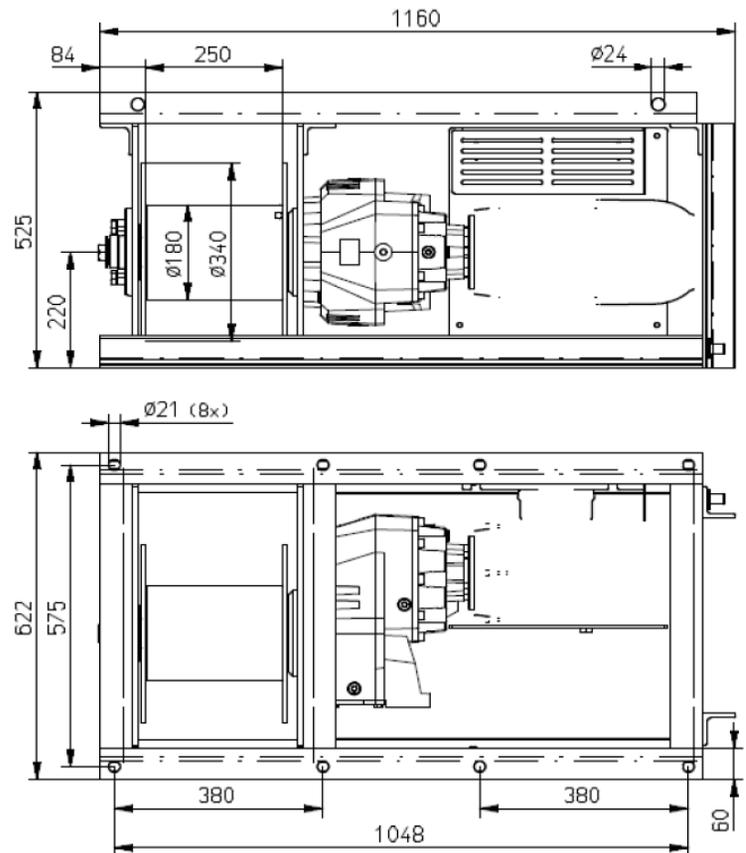
Die TEW1500 ist eine elektrisch angetriebene Hubwinde in einem Hochleistungsrahmen mit Befestigungslöchern. Frequenzumrichtersteuerung, Überlastschutz und Temperaturüberwachung sind Standard. Die kabelgebundene Fernbedienung verfügt über ein 8 Meter langes Kabel mit Not-Aus und einem Potentiometer zur variablen Geschwindigkeitsregelung. Die minimale Stromversorgung beträgt 16 Ampere. Das Stromkabel besitzt eine Standardlänge von 2,5 m.
